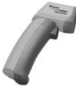
Рисунок 1.6 - Неконтактний інфрачервоний пірометр МТ-4 фірми Raytek [8]
